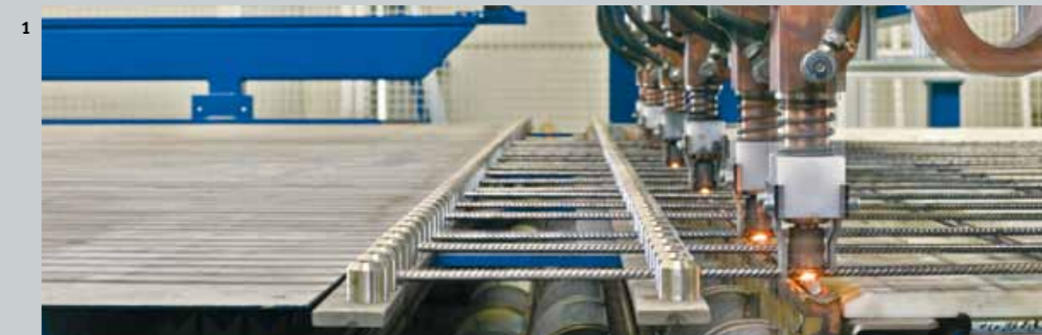
(1) robot de soudage pour la fabrication individualisée d'armatures préfabriquées (2) bétonnage automatique sur une palette mobile (3) rotation d'un coffrage de prémur Peter®
