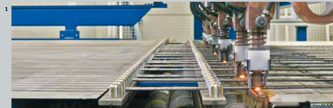
(1) Schweißroboter für die individuelle Herstellung von Fertigteilbewehrungen (2) automatisches Betonieren auf einer Umlaufplatte (3) Einwenden einer Peter® Doppelwandschale
